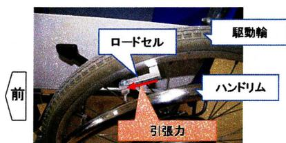
図11 ロードセルの取り付け位置
