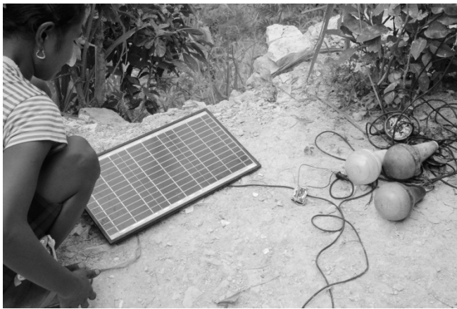
図8 ランプ・セヘンを使って携帯電話の電池を充電する様子
