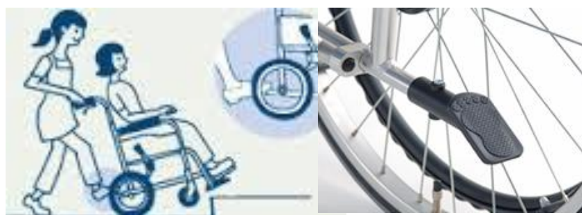
図 12 車いすのティッピングレバー
