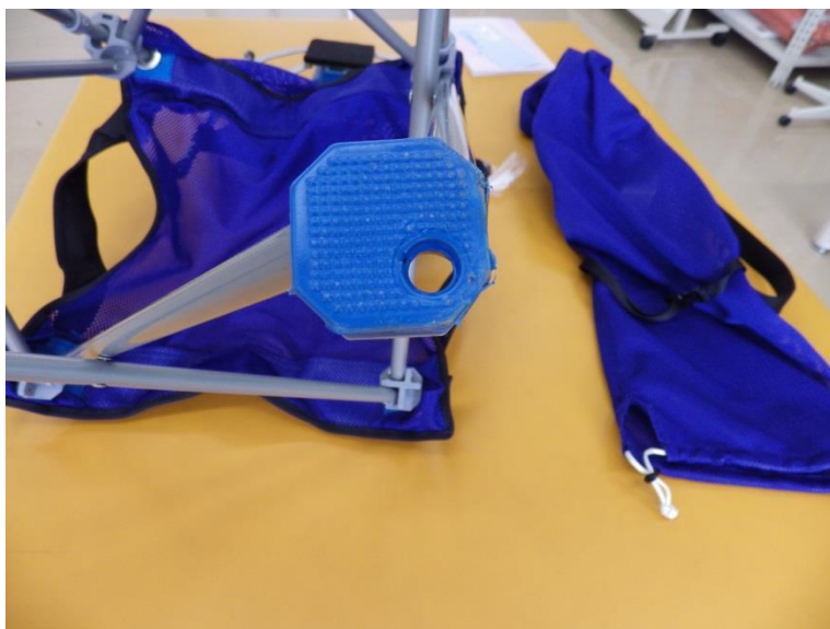
図 17 滑り止め加工した脚底面
