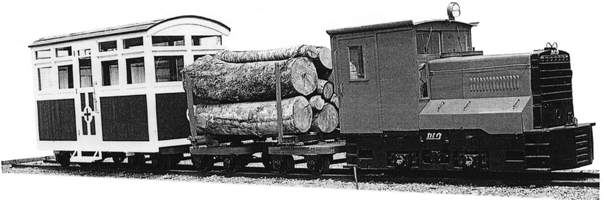
写真2 保存機関車（ディーゼル機関車）が運材台車と客車を牽引（1983年）
