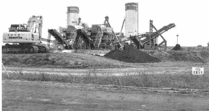
▲(写真2) 渡良瀬遊水地の第2調節池で進められている掘削事業の廃土調整装置
