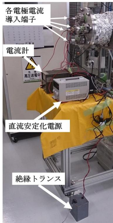
Fig.3.16 照射システム 2 の外部の写真
