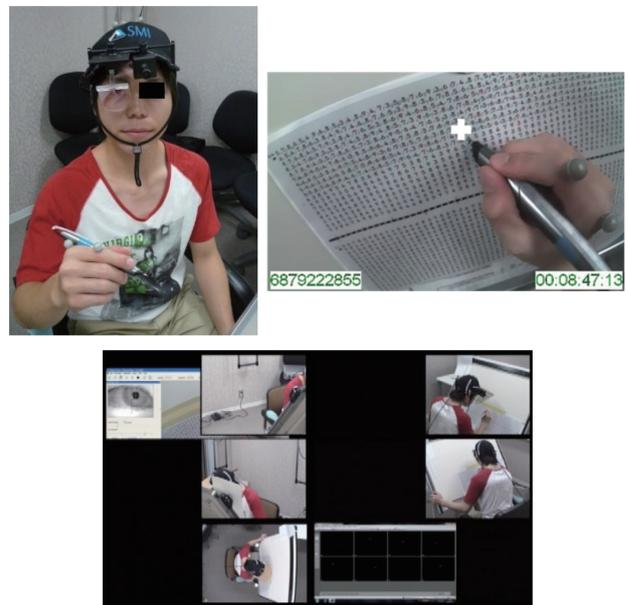
図3 視線追跡装置（左上）、視点の表示例（右上：+印）、CCD カメラ映像例（下）
