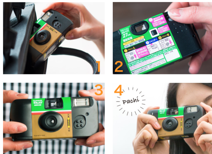
図 6-2. 写ルンですの使い方(FUJIFILM 「写ルンです」 より) [75]
