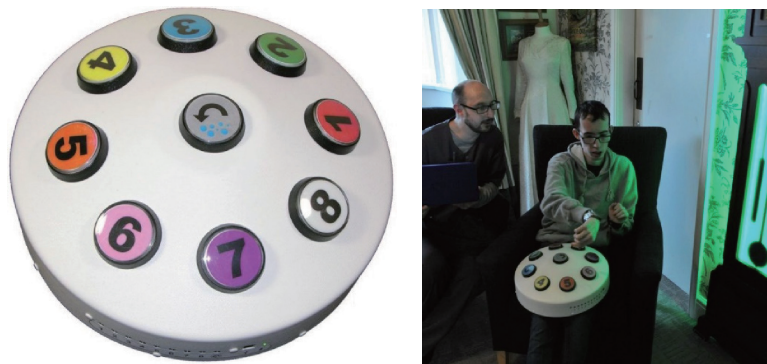
図3 ROMPA社のバブルチューブのLED色を変える装置 ROMPA社ホームページより転載 1)
