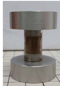
図 4.3 土粒子はアクリルパイプ内で成型される
