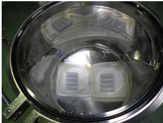
図 1.12 加圧方式による粉碎ロッド容器の密封性実験
