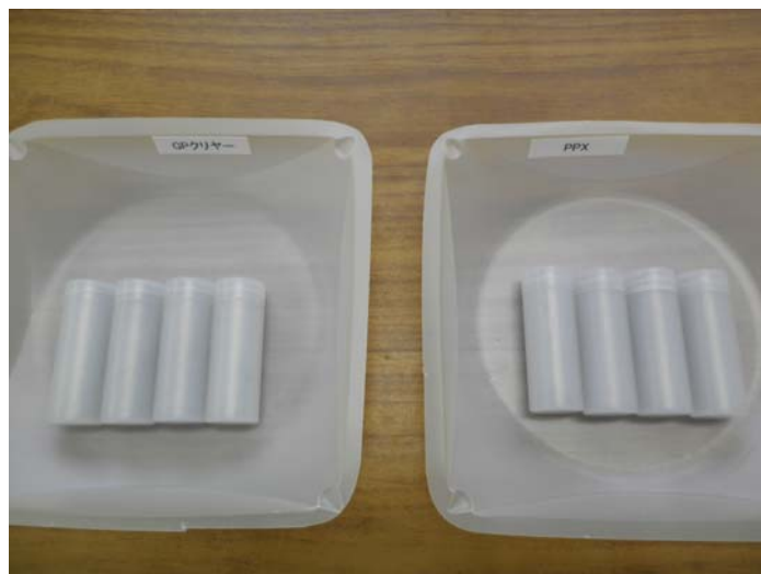
図 1.13 加圧方式による水没実験後の粉碎ロッド容器
