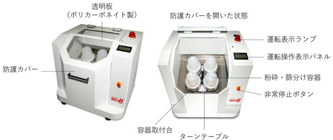
図2.1 遊星式ロッドミル, 左図は防護カバーを閉じた状態, 右図は防護カバーが開いた状態
