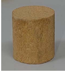
図 4.1 完成したソイルペレット
