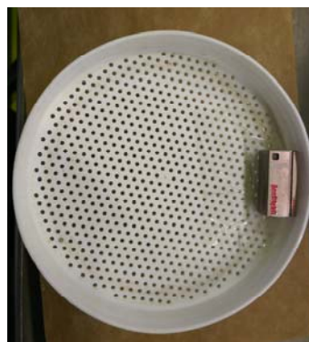
図 2.9 円孔篩に取り付けた加速度計
