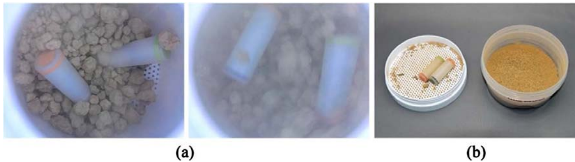
図 3.6 (a) 土粒と粉碎ロッド 2 本を入れて運転した, (b) 2 分間運転した後の結果
