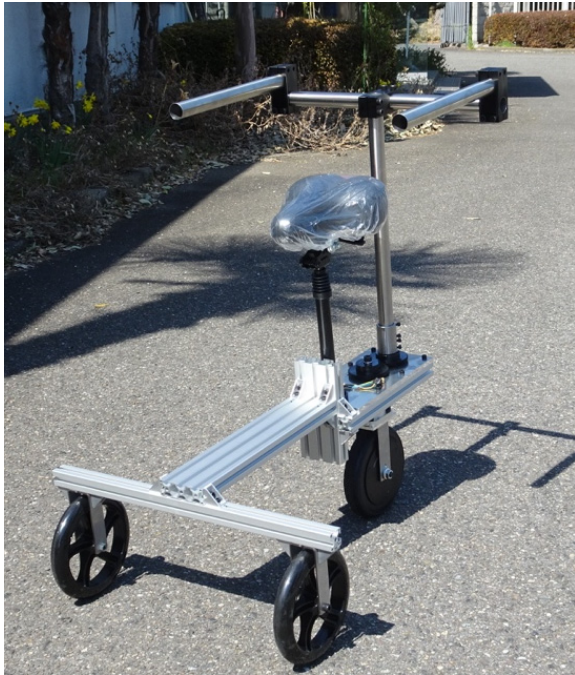
図5 後輪操舵 PMV 試作外観
