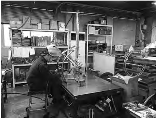
図21 スポーツ車椅子の製造
