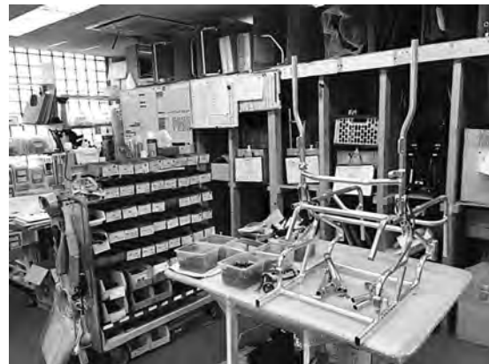
図10 製作中の車椅子フレーム
