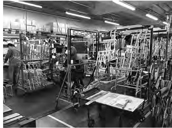
図22 標準型車椅子の製造
