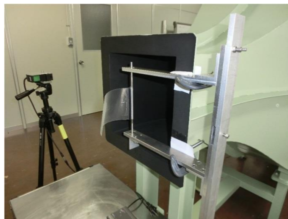
図 2 フラッタ試験装置
