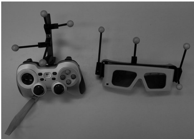
図6 コントローラと液晶シャッター眼鏡およびマーカ
