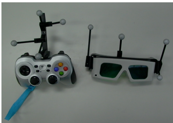
図3 HoloStage®-Miniで用いるコントローラと立体眼鏡。グレーのボールは位置と向きを赤外線カメラで計測するためのマーカである。
