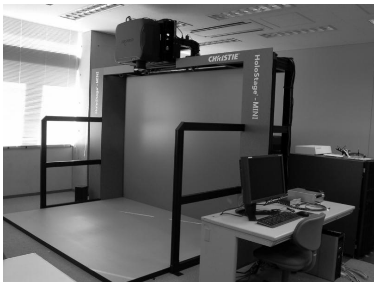
図2 VR装置全体。正面の映像は背面から投影する。
